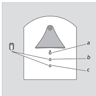
Монтажные отверстия (b и c) заблокированы двумя маленькими винтами, и для того, чтобы вы смогли воспользоваться отверстиями, винты следует выкрутить.
