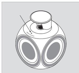
**Световой индикатор:** *при ежедневном пользовании индикатор светится либо красным (режим ожидания), либо зеленым светом (воспроизведение). Если произошел сбой или акустические колонки перегрелись, свечение изменится на желтое.*
